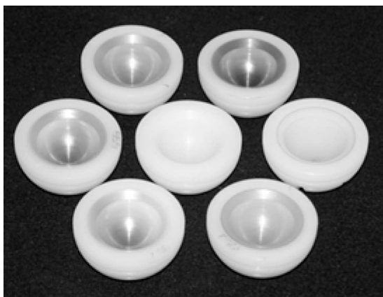
3. Ábra. Nitrogén plazma immerziós ionimplantációval kezelt polietilén csípőízületi endoprotézisek. A középső darab kezeletlen.
