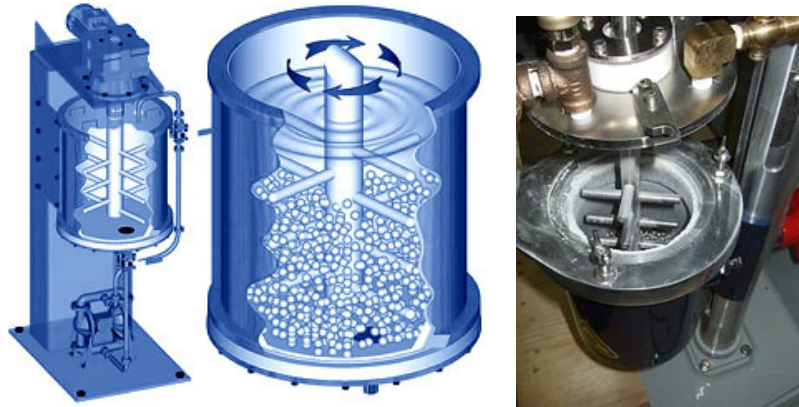
2.1. 20. ábra: A montmorillonit őrléséhez alkalmazott UP-HD/HDDM-01 típusú attritor és a sematikus képe
