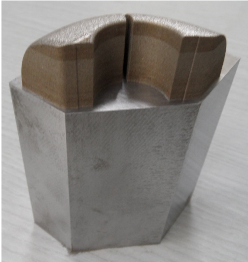
1.3.33. ábra: Előgyártmányra szinterezett szerszámbetét ( hybrid mold ), megmunkálás előtt és után [46]
