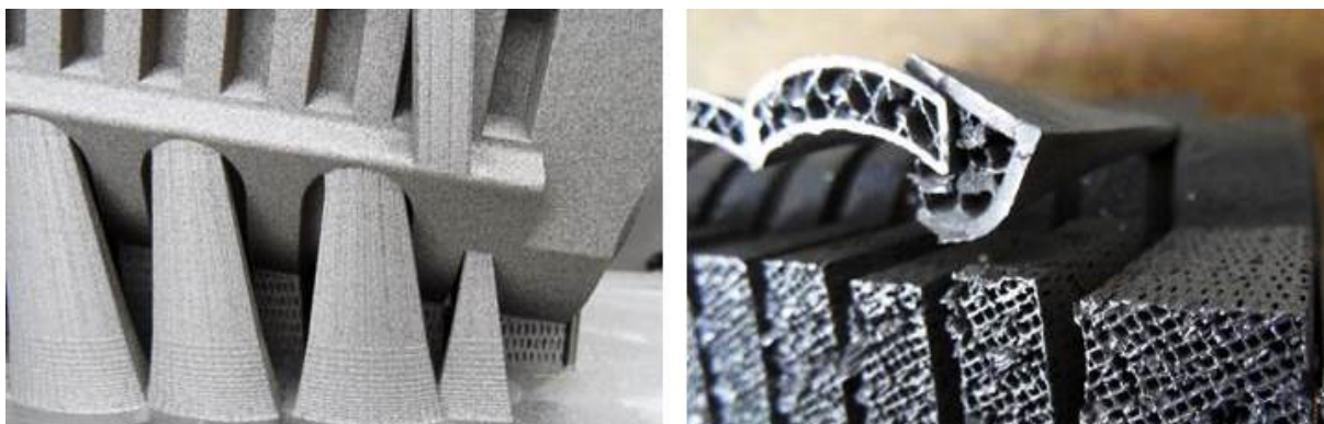
1.3.8. ábra: munkadarab támasztékkal ellátva (bal), a támaszték belső szerkezete (jobb)
