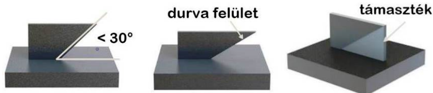
1.3.23. ábra: Kritikus alsó felületek építése (támaszték alkalmazása) [39]
