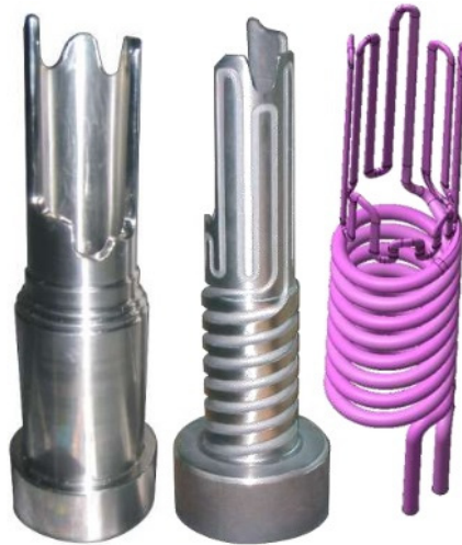
1.3.27. ábra: Szerszám betét formakövető hűtéssel [41]
