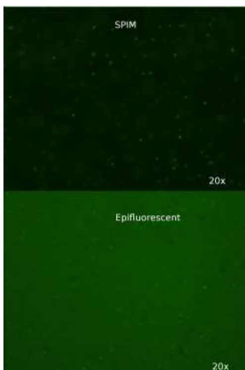
22. ábra. Az általunk fejlesztett szelektív sík-megvilágítással (SPIM) készített felvétel a normál epifluoreszcens megvilágítással összevetve. Átlátszó 5%-os Agar gélbe ágyasztunk 2\ \mu\text{m} -es zölden fluorszekáló gyöngyöket. A SPIM érdemben csökkentette a nem a fókuszsíkban lévő gyöngyökből érkező háttérrel. (20x-os nagyítású objektív, NA 0.4.)
