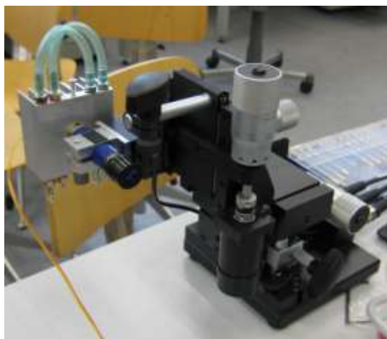
21. ábra. Vízhűtéses kék lézerdióával és diffrakciós vonalgenerátor optikával felszerelt mikromanipulátor szelektív sík-megvilágítású mikroszkópiához.
