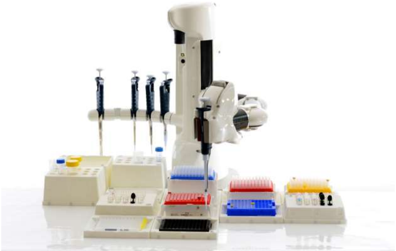
6. ábra. Antropomorf pipettázó robot 12 . Általában azonban derékszögű koordinátarendszerben mozgó és speciális, nem az emberek számára készült pipettát vezérelnek a robotok.
