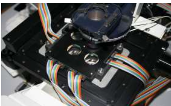
e: 4-kutas mikroszkóp-inkubátorunk Leica inverz mikroszkóp motorizált asztalán.
