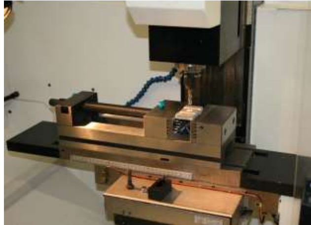
b: A CellMovie CNC marógépe, melyen az ELTE Biológiai Fizika Tanszékén az inkubátorokat gyártottuk.
