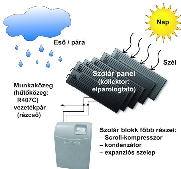
5. ábra. Légtermikus hőszivattyú (DX-rendszerű villamos hőszivattyú)
