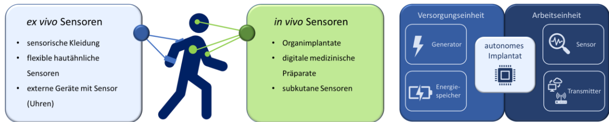
Abbildung 1: Anwendung von ex vivo und in vivo Sensoren und der Aufbau eines autonomen Implantates.
