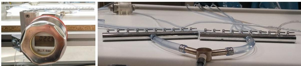
Abbildung 4-4: Druckmessdose (links) und Wasserverteiler mit den PVC-Schläuchen (rechts)
