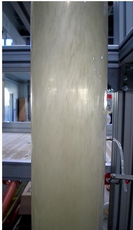
Abbildung 6-45: Verteilung der Feststoffpartikel in dem vertikal durchströmten Rohrabschnitt
