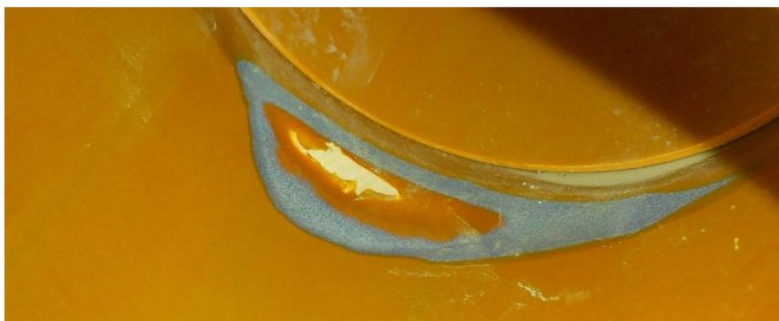
Abbildung 7-2: Durchbruch eines KG-Rohrs
