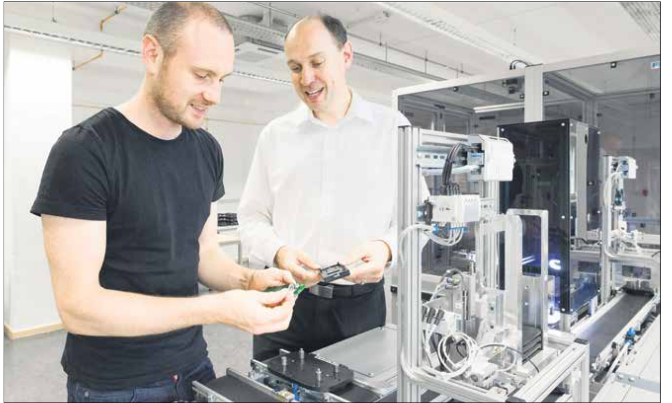
Modellfabrik 4.0 – eine produktionsnahe Testumgebung der Arbeitsgruppe Smart Production Systems zu Forschungs- und Entwicklungszwecken – speziell für den Mittelstand – unter der Leitung von Prof. Dirk Reichelt an der Fakultät Informatik/Mathematik der HTW Dresden. Prof. Reichelt (r.) erläutert seinem Doktoranden und Wissenschaftlichem Mitarbeiter Eric Starke den Aufbau eines Werkstückträgers. Foto: HTW Dresden/Peter Sebb
