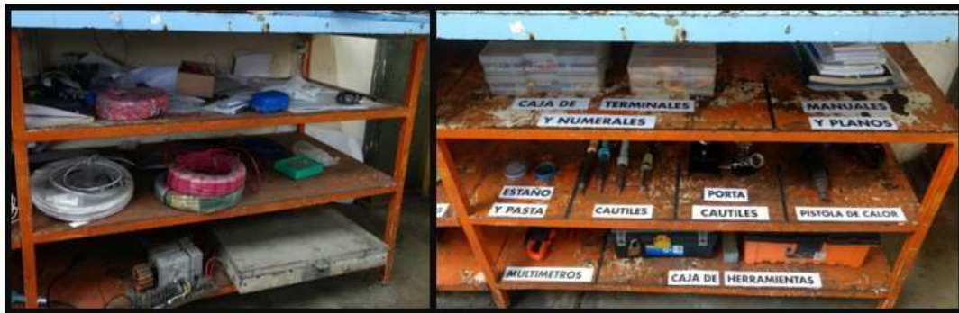
Figura 35: Seiton en la división 3, parte inferior (área eléctrica).
