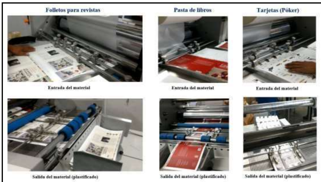
Figura 15: Ejemplos de algunos casos de aplicación de la máquina plastificadora
