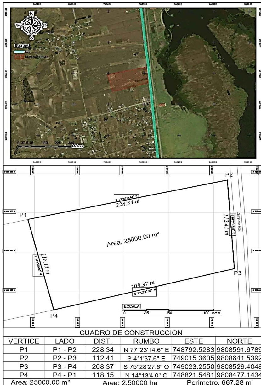
Figura 8-3. Georreferenciación y levantamiento planimétrico.
