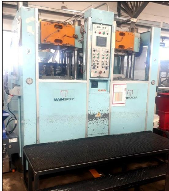
**Figura 5-3.** Máquina MG-Estacionaria BS-150 en Planta de Inyección
