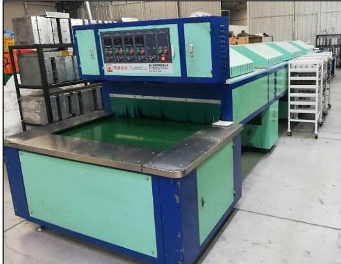
**Figura 9-3.** Túnel Estabilizador de EVA en Planta de Inyección
