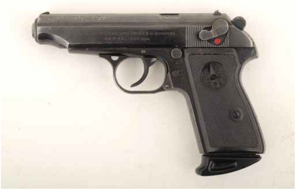
A Fémáru-, Fegyver- és Gépgyár által gyártott 48M 7,65 mm-es öntöltő pisztoly. (Szikits Péter felvétele. HM HIM gyűjteménye)
