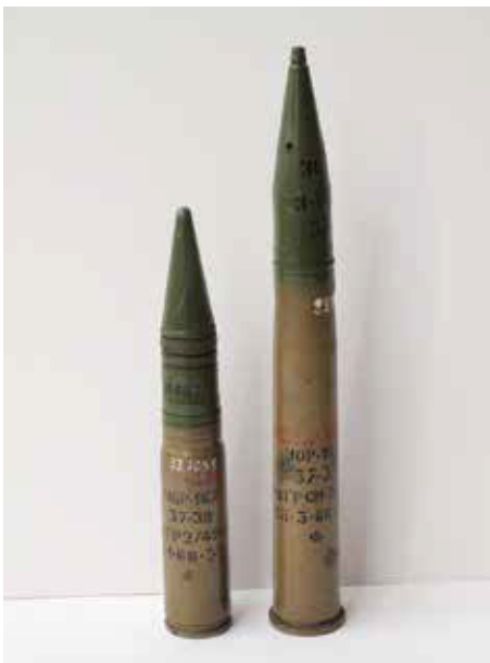
37 mm-es N-37 repülőgép fedélzeti gépágyú páncéltörő lőszer, 37 mm-es 48M légvédelmi gépágyú repeszlőszer; illetve 57 mm-es ZiSz-2 páncéltörő ágyúhoz úrméret alatti páncéltörő gránát, páncéltörő és repeszlőszer.
