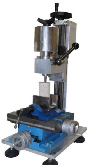
Abbildung 81: Cerchar-Gerät an der TU Bergakademie Freiberg.
