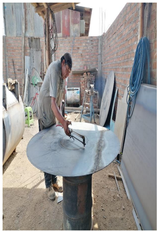
Armado de rompeolas.
