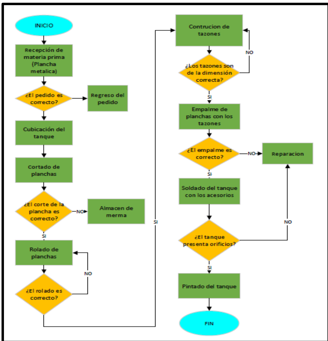
Figura 5: Flujograma de Fabricación de tanques estacionarios y cisternas en Industrias Metálicas El Sol. Elaboración Propia.
