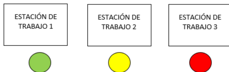
Figura 43: Estaciones de trabajo con sistema Andon
