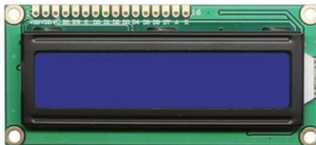
Figura 29. Display LCD 16x2 Fuente: Hitachi, Matrix Liquid Crystal Display Controller/Driver
