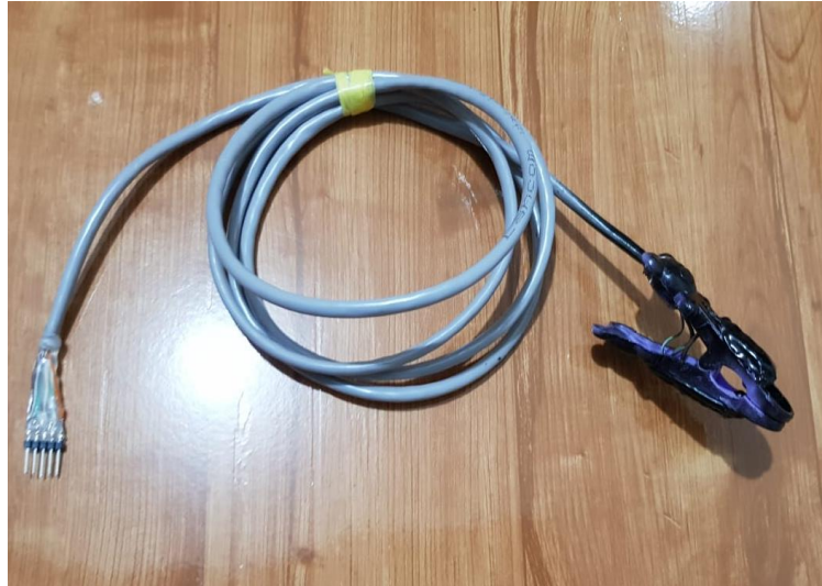
Figura 40. Sonda oximétrica conformada por gancho y cable UTP
