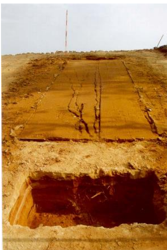
7. kép: Eső-szimulátorral végzett mérések épített rézsűszakaszon
