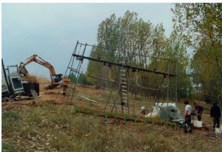
7. kép: Eső-szimulátorral végzett mérések épített rézsűszakaszon
