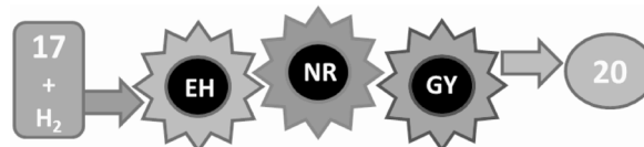
9. Ábra. 2-Nitrofenilpiroszölösav észterek ( 17 ) enantioszelektív kaszkád reakciójának ábrázolása, ahol EH : enantioszelektív hidrogénezés, NR : nitro redukció és GY : gyűrűzárás; fekete alapon a Pt felületen lejátsszó lépések.
