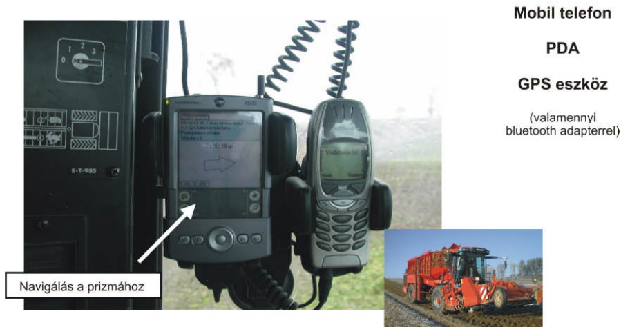
5. ábra. A betakarítógépre telepített hardver
