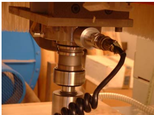
4. ábra – A gyorsulásérzékelő rögzítése a szerszámtengely csapágyazásán
