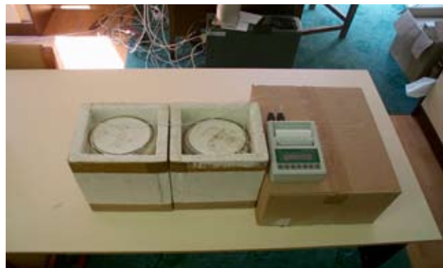
1. ábra – A hidratációs hőmérséklet mérése Therm 6280-2 típusú készülékkel
