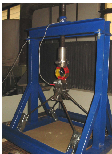
4. ábra – Munkadarab leszakító berendezés mérő gyűrűvel
