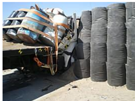
4. ábra DEFENCELL elemek tesztelése járművekkel [5]
