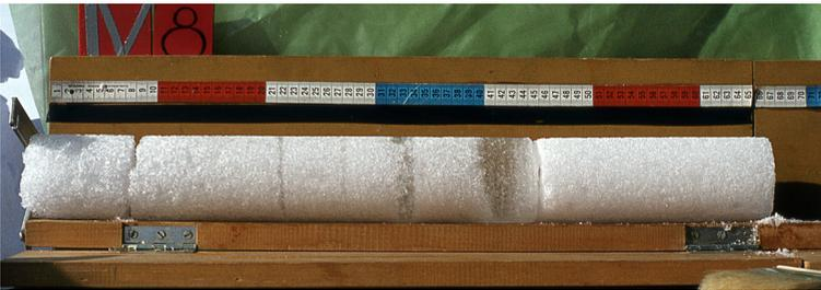
**Abb. 6.1-6:** Ein 66 cm langes Stück aus dem Eisbohrkern IV aus dem Vernagtferner (ein Gletscher in den Öztaler Alpen in Tirol), erbohrt im März 1983. Es stammt aus einer Tiefe von ca. 6 m. Charakteristisch für Kerne aus alpinen, temperierten Gletschern sind die alljährlich auftretenden Eisschichten im Firn, die beim Gefrieren von eingeseickertem Schmelzwasser entstehen (Foto: Hans Oerter).
