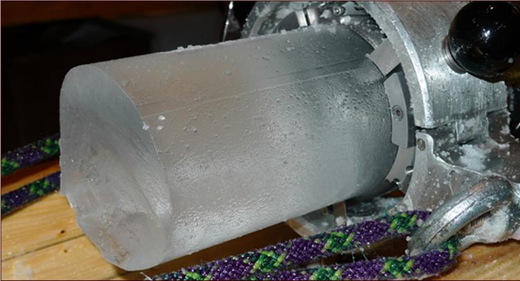
**Abb.6.1-5:** Eiskern, NEEM-Tiefbohrung in Grönland 2010. Ab einer Tiefe von ca. 1.000 Metern verschwinden infolge des hohen Druckes die Luftblasen und die eingeschlossene Luft wird in Form von Klathraden oder Gashydraten in die Eiskristalle eingebaut. So wird das Eis immer transparenter bis es glasklar ist (Foto: Sepp Kipfstuhl).
