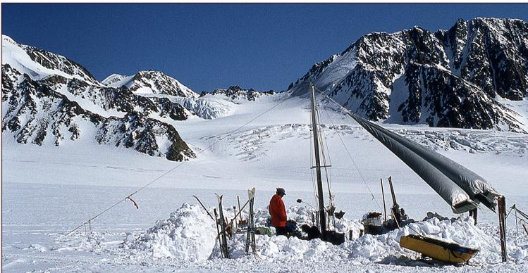
Abb. 6.1-3: Der Vernagtferner (ein Gletscher in den Ötztaler Alpen in Tirol). Das Foto zeigt die Entnahme von Eisbohrkernen im oberen Firnbecken des Gletschers unterhalb des Taschachjochs im März 1983. Das Bohrprojekt wurde im Rahmen des SFB81 an der TU München in Zusammenarbeit mit der Universität Bern (Bohrausrüstung) durchgeführt (Foto: Hans Oerter).
