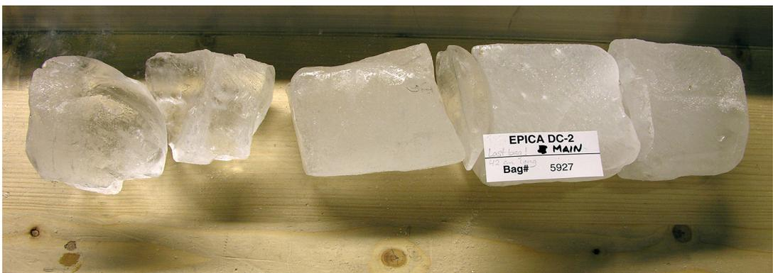
**Abb. 6.1-4:** Letztes erbohrtes Kernstück aus dem EPICA-Eiskern von Dome C. Es sind die bislang weltweit ältesten erbohrten Eiskernstücke (Foto: Hans Oerter).
