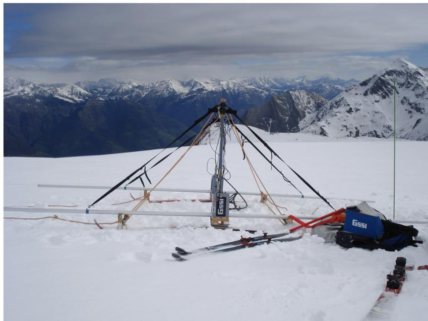
**Abbildung 2.2:** Das GPR der Firma GSSI in der verwendeten Konfiguration.
