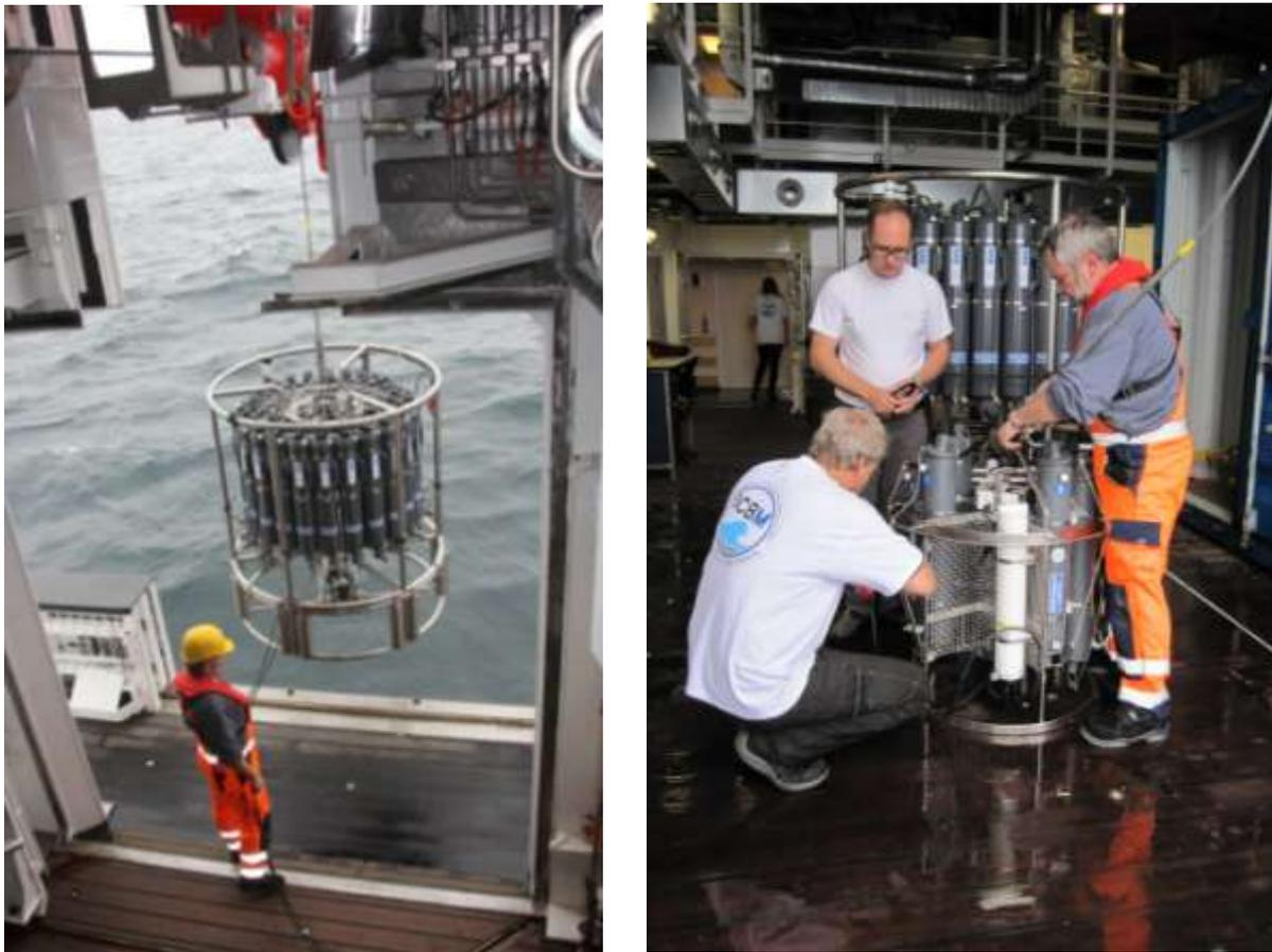
Abb. 5.4-3: Aussetzen der CTD-Rosette (links) und Test einer eigenen CTD-Rosette (rechts)
