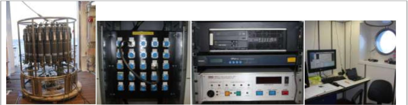
CTD-Rosette → Einleiterkabel → Windenanschlussfeld → Deckseinheit → PC mit Software
