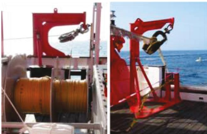
Umlenkung der Streamer montiert. Außerdem waren auf diesen Fundamentplatten auch Ablaufrollen für die Führung und Umlenkung der Schleppdrähte für die Luftpulser vorgesehen.
