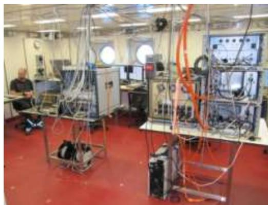
**Abb. 5.2-1** Die Navigation und seismische Datenaufnahme (links) im Nasslabor II erfordert eine umfangreiche Verkabelung (rechts), die über enge Kabeldurchlässe bis zum Arbeitsdeck reicht.
