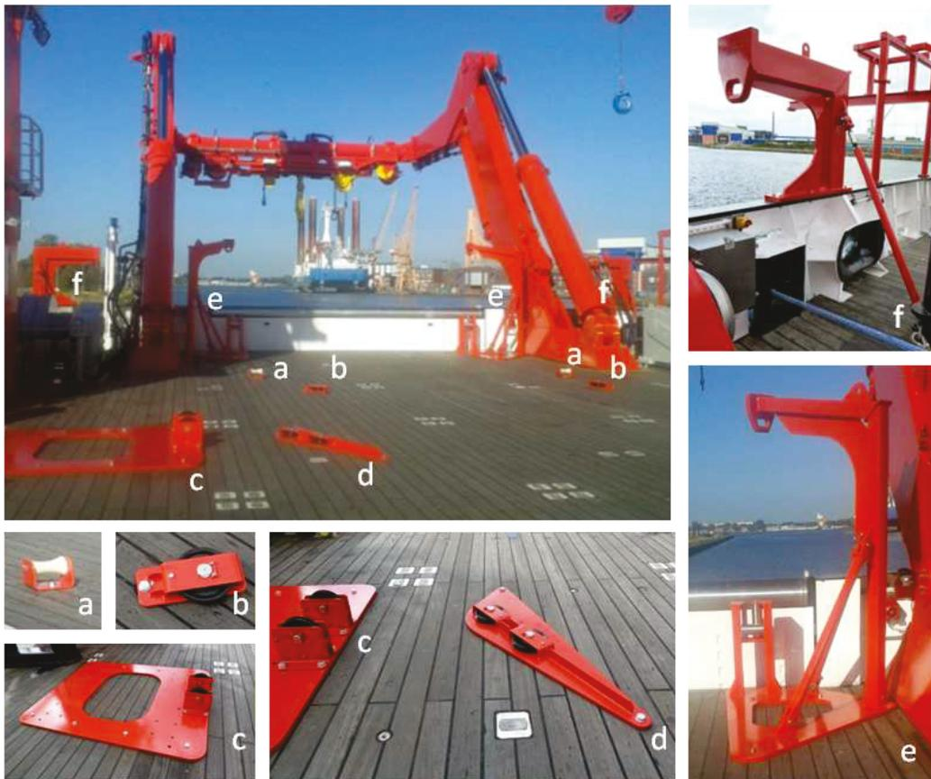
Abb. 5.1.-1.: Montageposition der zusätzlichen Adapterplatten (a-d) und Pylone (e, f) für die 3D-Seismik der BGR auf dem Arbeitsdeck und dem Schanzkleid
