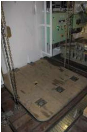
Abb.6: Der Messkorb wird unten mit Bolzen befestigt, eine Bewegung / Vibration durch Schiffsbewegungen- oder Welleneinfluss ist somit minimiert.
