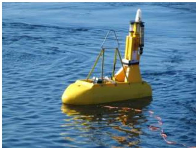
**Abb. 5.1.1-1** Die frei treibende Boje trägt das erste Hydrophon 20 m unter der Wasserlinie und das zweite Hydrophon 20 m über dem Meeresboden in ca. 80 m Tiefe. Ferner ist die Boje mit zwei GPS Empfängern, der Kongsberg UHF Antenne und einer CTD zur Tiefenmessung ausgerüstet.
