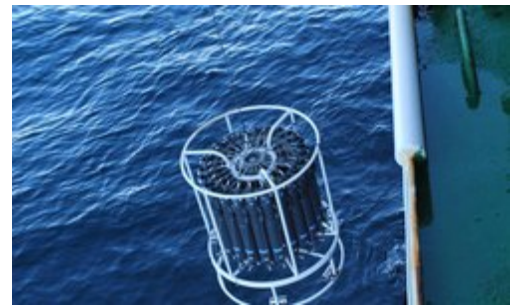
Die CTD-Sonde mit Rosette wird ins Wasser gelassen. (© K. Bumke)
