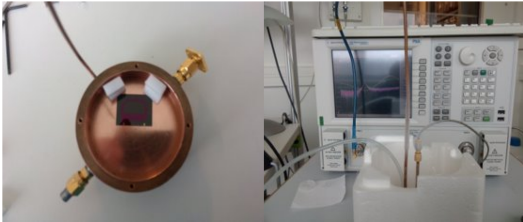
Figure II-7: Résonateur dans une cavité de cuivre plongé dans l'azote liquide.
