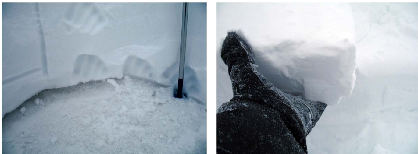
Fig. 73 Placa de nieve: resistencia lateral fuerte (izda), y manto asentado sobre capa de nieve granulada: resistencia basal débil (dcha)
