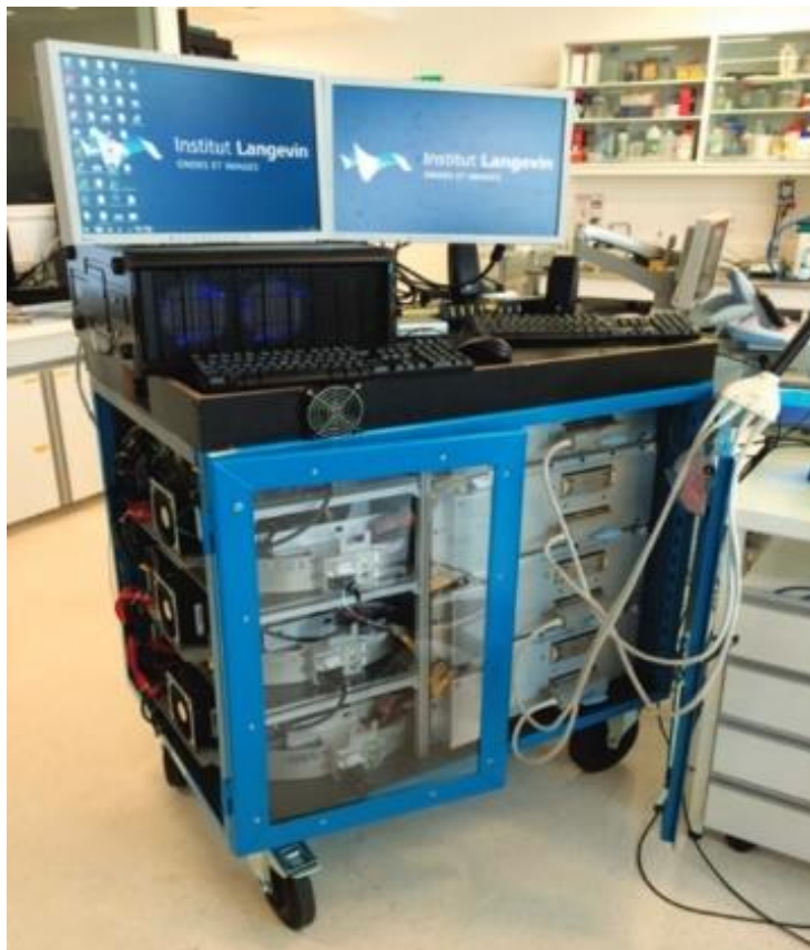
Figure 1.2 - Configuration pour l'imagerie ultrasonore ultrarapide 3D. Le système comprend quatre échographes Aixplorer (Supersonic Imaging, Aix-en-Provence, France) avec 1024 canaux en émission et 512 en réception, et 5 ordinateurs. Extrait de (Gennisson et al., 2015). © 2015 IEEE
