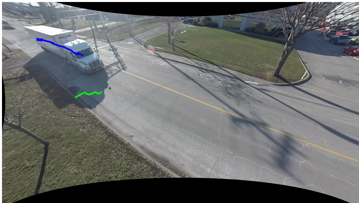
Figure 3.10 Exemple de sur-segmentation due à l'ombre d'un usager.
