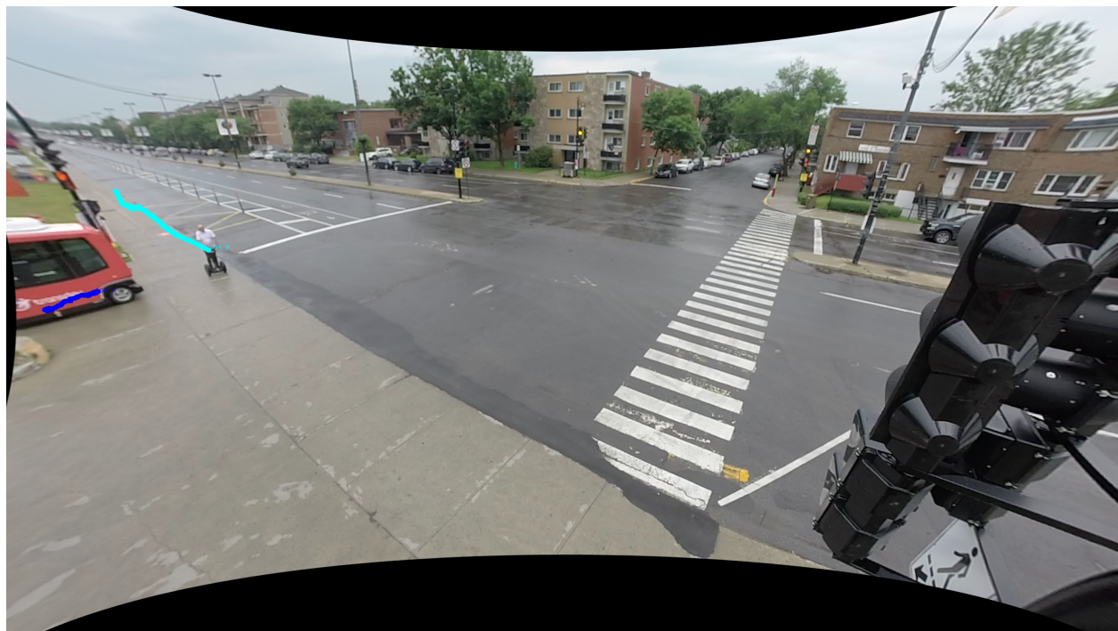
Figure 5.14 Situation dangereuse ( TTC_{15} = 0.9927s ) où un homme sur un gyropode traverse sur un feu rouge, face à une navette qui entamait le franchissement du carrefour.
