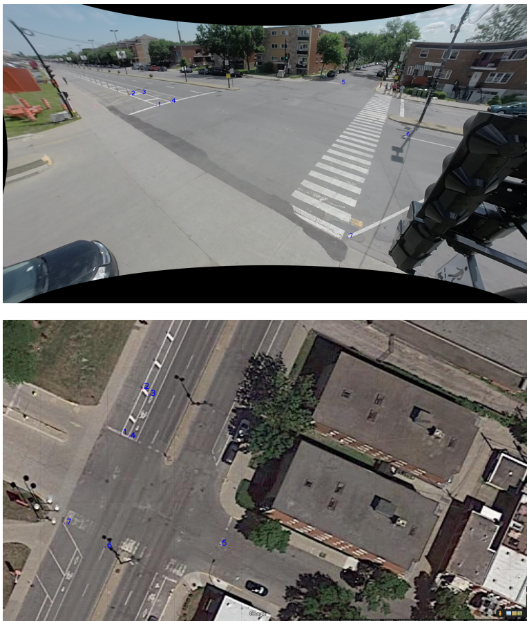
Figure 3.3 Points de correspondances (numérotés en bleu) dans les deux espaces pour obtenir une homographie.
