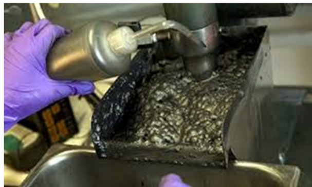
Figure 1-3 : Flottation des sulfures (COREM)
