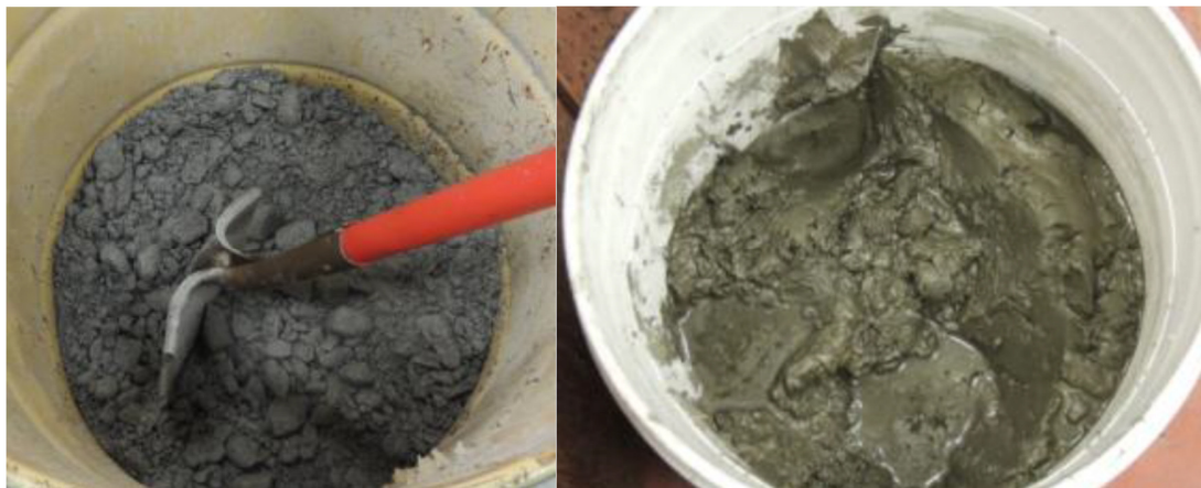
Figure 3-1 : À gauche, les stériles et à droite les résidus miniers de la mine LaRonde
