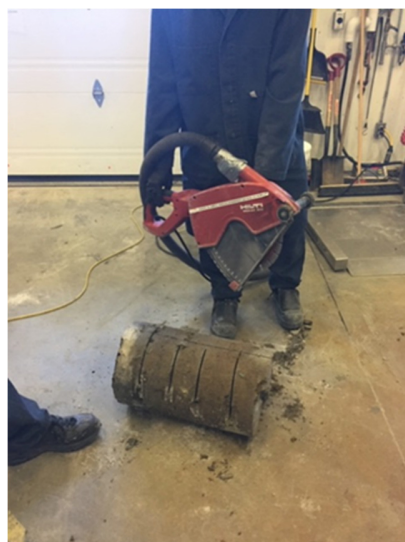
Figure 3-27 : Coupe des tranches de la colonne C2
