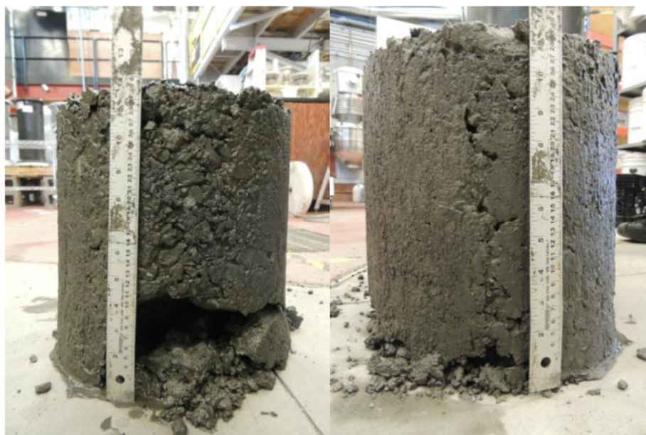
Figure 3-18 : Création de chemins préférentiels dans le paste rock
