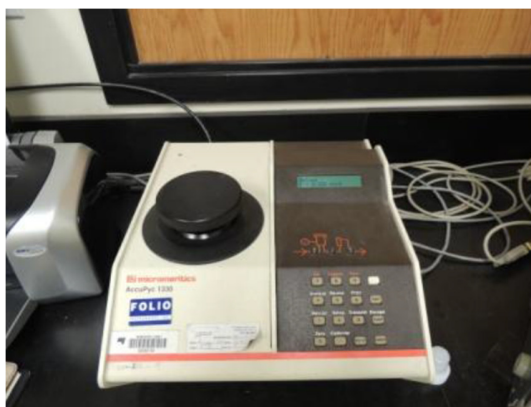
Figure 3-4 : Pycnomètre à l'hélium AccuPyc 1330 Micromeritics
