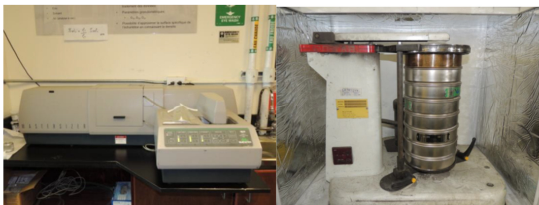
Figure 3-2 : Granulomètre au laser (à gauche) et granulomètre électrique (à droite)
