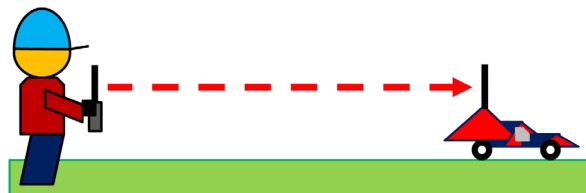
Abb.7 Abstrahlung und Empfang bei optimalen Antennenausrichtungen
