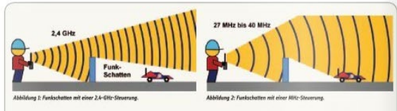
Abbildung 1: Funkschatten mit einer 2,4-GHz-Steuerung. Abbildung 2: Funkschatten mit einer MHz-Steuerung.
