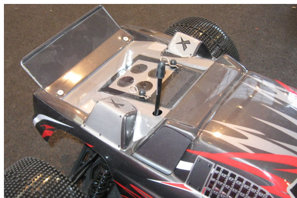
Abb.11 Senkrecht montierte Empfängerantenne in der Praxis
