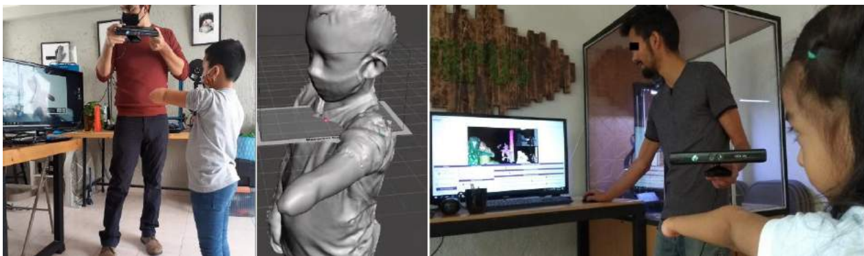
Figura 15. Levantamiento antropométrico digital con escáner 3D. Fuente: elaboración propia.
