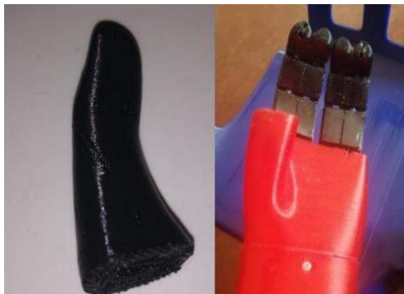
Figura 47. prótesis de usuario 1 con fractura en dedo pulgar. Fuente: elaboración propia.
