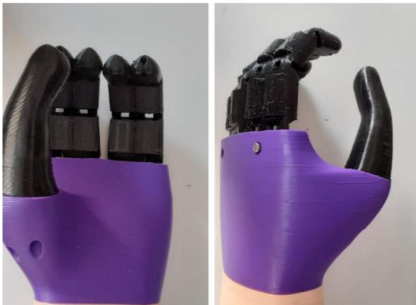
Figura 34. Pulgar rígido que si se opone al resto de los dedos para aumentar fuerza de presión. Fuente: elaboración propia.
