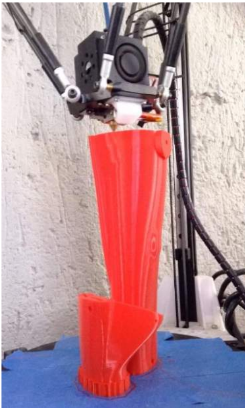
Figura 41. Impresión conjunta de socket y dispositivo terminal. Fuente: elaboración propia.
