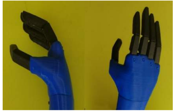
Figura 26. Prototipo con dimensiones proporcionadas para usuarios infantiles. Fuente: elaboración propia.
