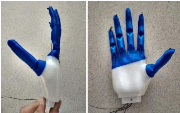
Figura 20. Modelo de pieza con palma impresa en PLA y falanges impresas en TPU. Fuente: elaboración propia.
