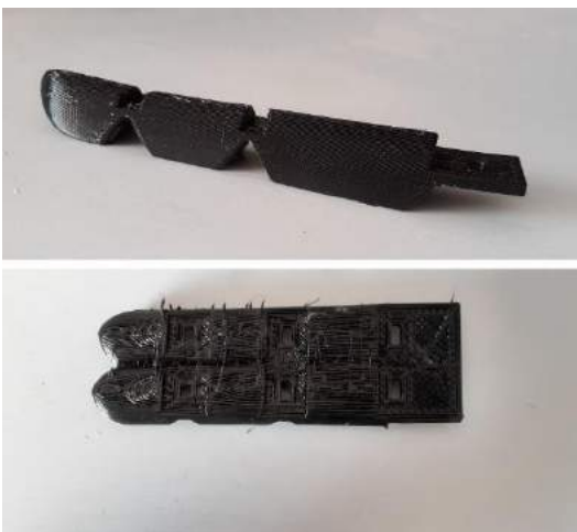
Figura 28. Combinación de dedos para reducir número de cordones tensores. Fuente: elaboración propia.
