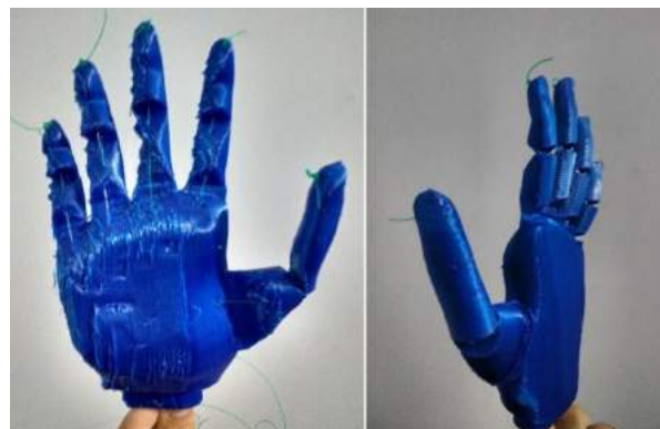
Figura 19. Modelo de pieza completa de mano con muescas, impresa en TPU. Fuente: elaboración propia.
