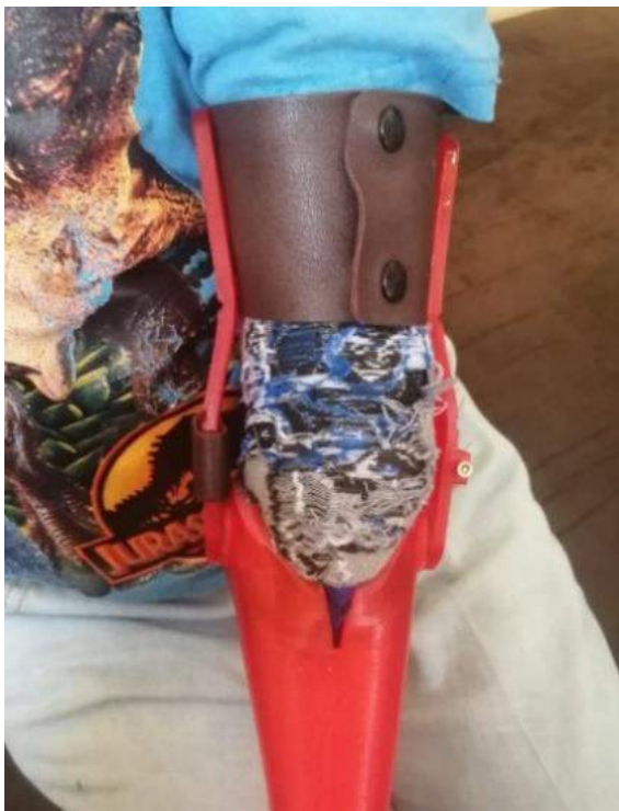
Figura 46. Muñón de usuario deslizándose fuera del socket. Fuente: elaboración propia.
