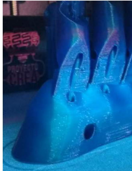
Figura 21. Se tiene poca resistencia mecánica al flexionar cuando la veta de impresión converge con el eje de doblez de la articulación. Fuente: elaboración propia.
