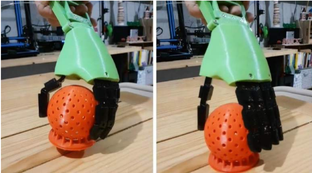
Figura 33. Pulgar cediendo fuerza de presión ante la oposición de los otros dos tensores. Fuente: elaboración propia.
