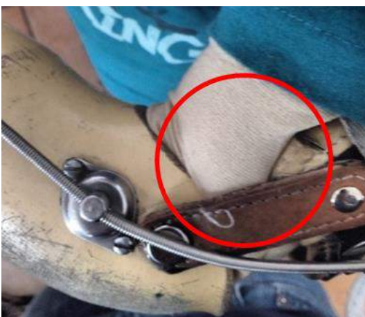
Figura 5. Se aprecia la compresión en el músculo del muñón debido al desajuste dimensional del socket por crecimiento. Fuente: elaboración propia.
