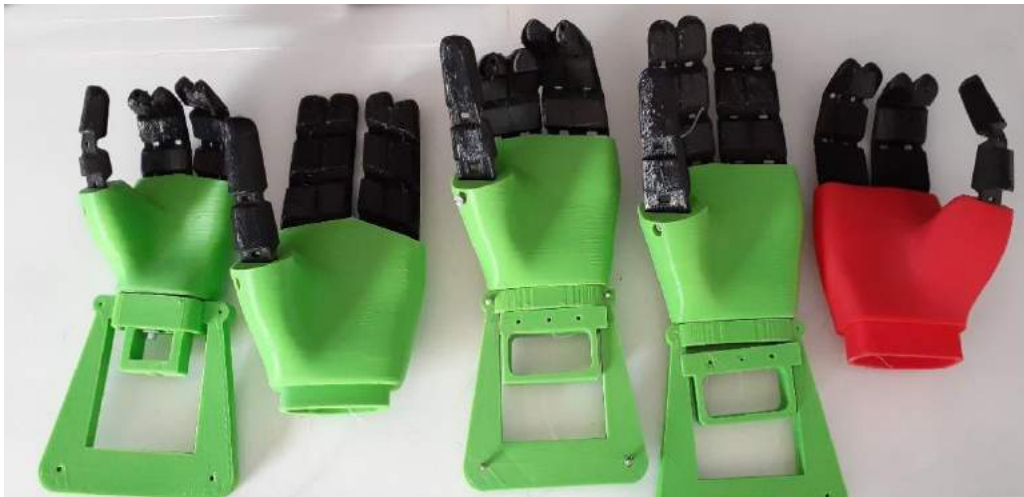
Figura 31. Modelos con variaciones en posición de articulaciones y dedo pulgar. Fuente: elaboración propia.
