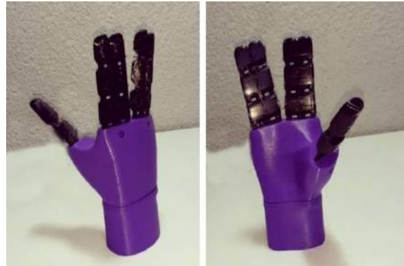
Figura 29. Dispositivo terminal de tres dedos, con apariencia de cinco. Fuente: elaboración propia.
