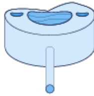
Figura 19 - Exemplo de uma moldação incompleta [40]
