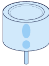
Figura 22 - Exemplo de uma moldação com prisões de ar [40]
