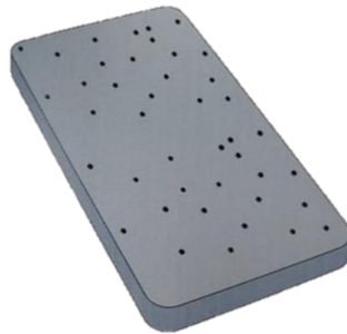
Figura 21 - Exemplo de moldação com pontos negros [38]
