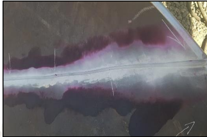
Figura 91 Inspección Líquidos Penetrantes de Tapa Toriesférica
