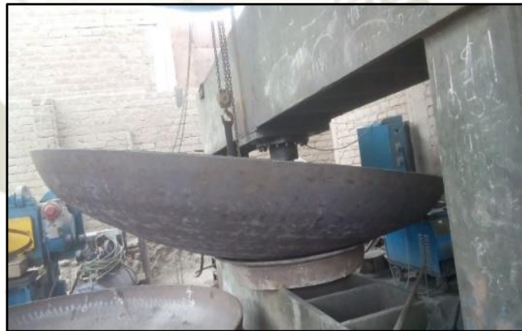
Figura 90 Proceso de Bombeado de Tapa Toriesférica Fuente: Elaboración propia
