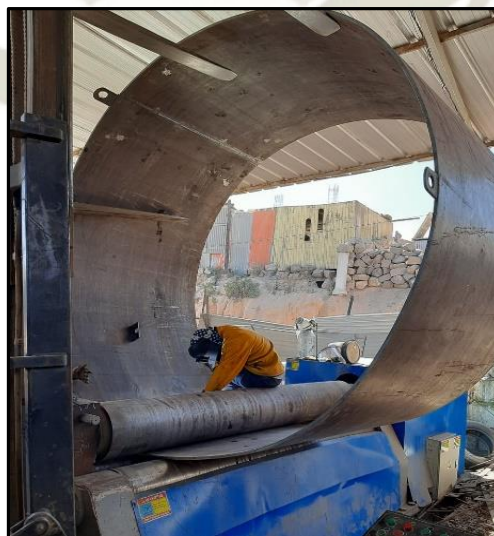
Figura 87 Rolado Virolas de \phi 2850 mm y Longitud 1500 mm Fuente: Elaboración Propia
