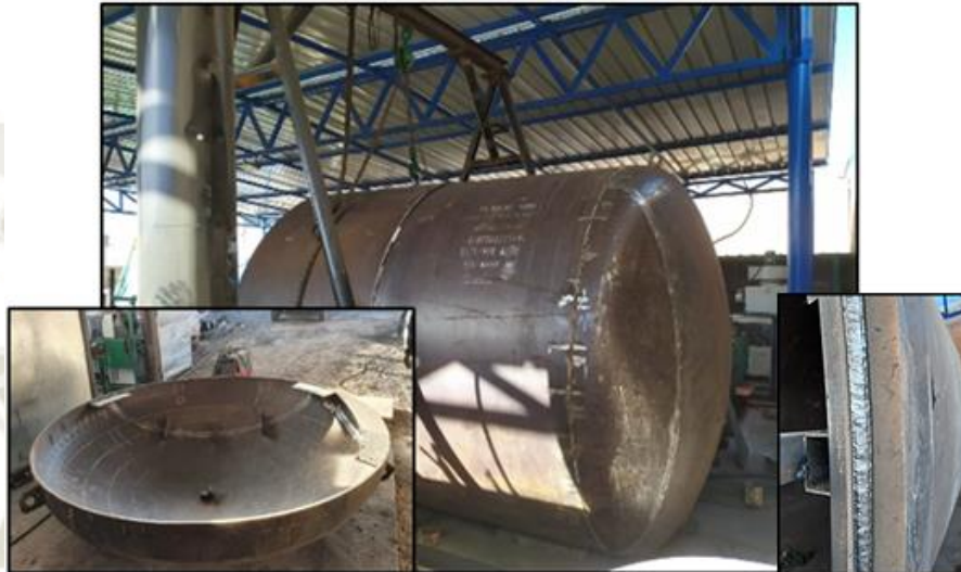
Figura 101 Armado de Virolas y Tapas Toriesféricas
