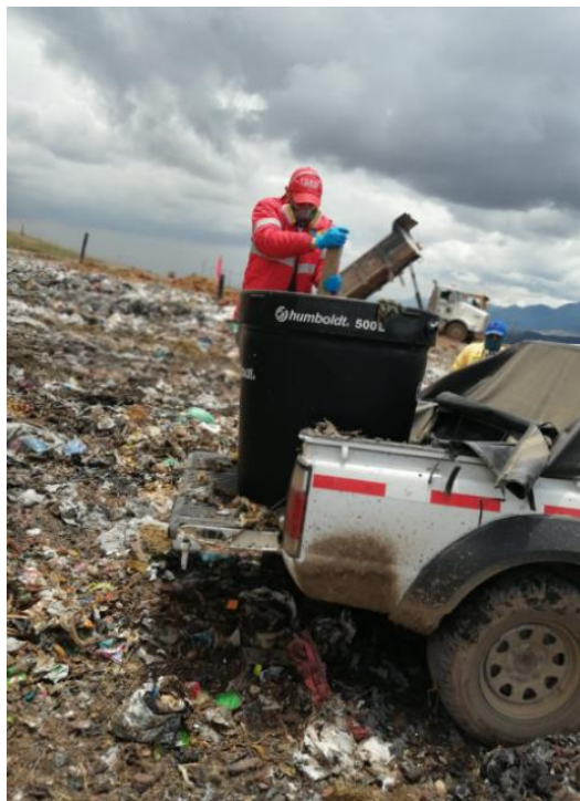
Figura 2-7 Compactación manual del tanque No. 1
