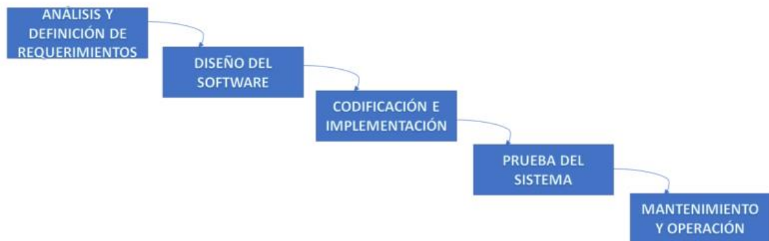
Ilustración 10. Metodología en cascada usada en el desarrollo del software
