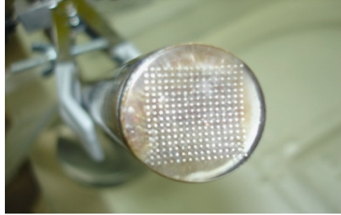
Figura 2.1: Electrodo múltiple de registro ventricular empleado en los experimentos de la presente tesis doctoral. En la imagen se observan los 256 electrodos unipolares que conforman la placa.
