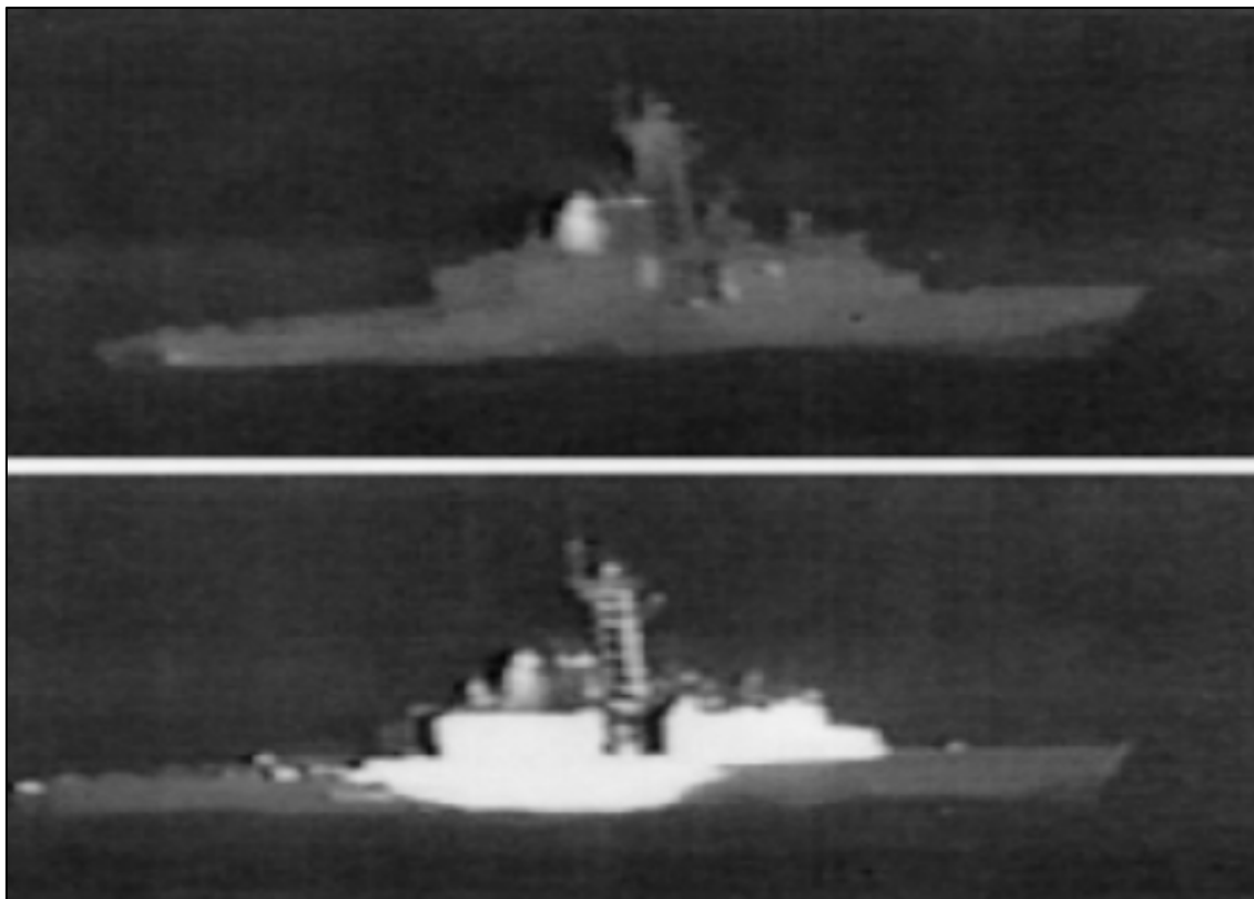
Ilustración 3.4 Destello solar correspondiente a una pintura color gris naval [16]
