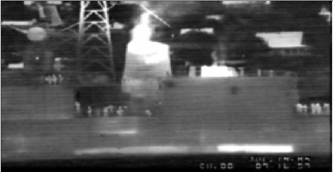
Ilustración 3.2 Imagen IR correspondiente a un barco sin ningún tipo de contramedida IR activada [16]
