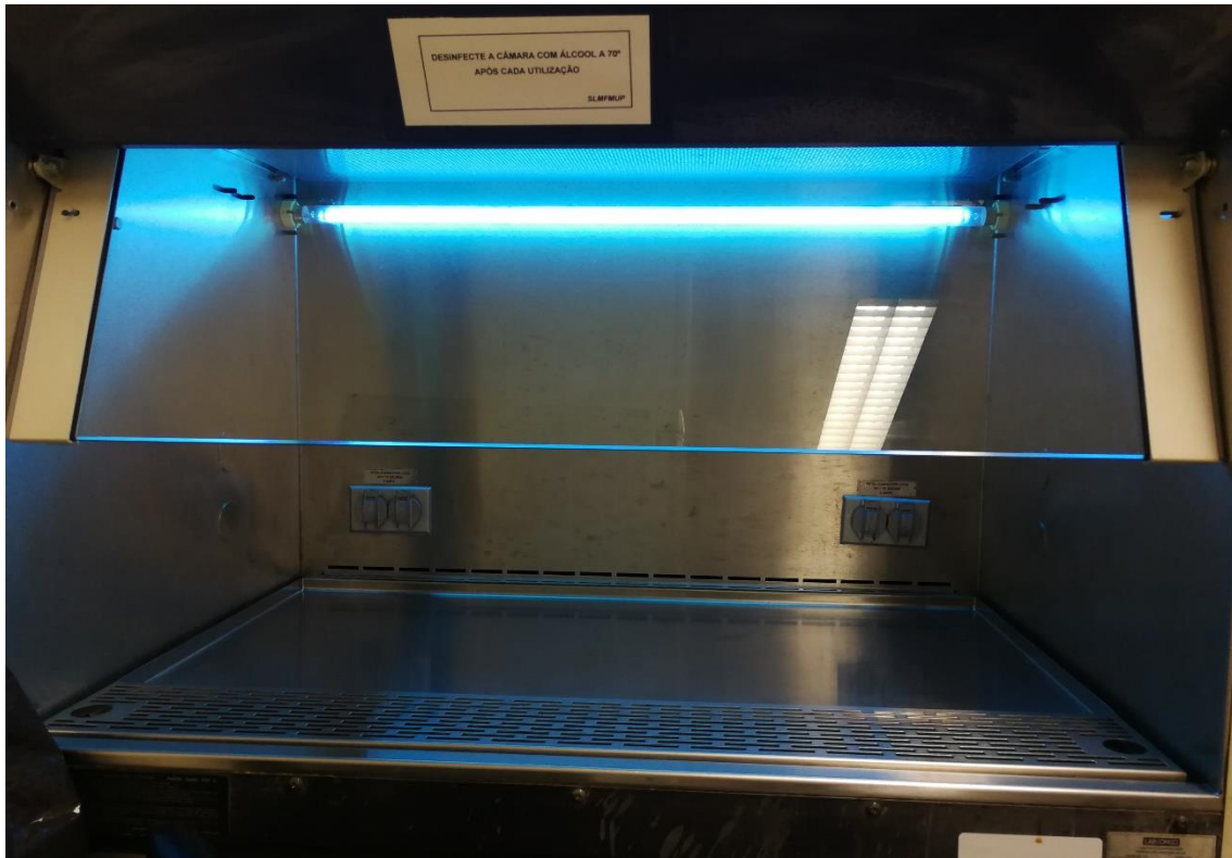
Fig. 2: Câmara de Fluxo laminar com lâmpada UV-C utilizada nas experiências.
