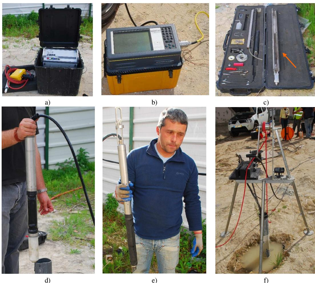
Figura 6. Alguns aspetos da execução dos ensaios CH, com *sparker*, no campo experimental: a) gerador de impulsos e unidade de controlo; b) sismógrafo; c) calha com bússola para *sparker* nas ondas S; d) sistema de aquisição tri-axial; e) sonda *sparker*; f) aspeto geral da sonda *sparker* instalado no furo.
