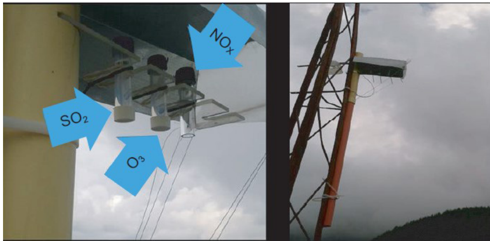
Figura 27. Muestreador pasivo para NO x , SO 2 y O 3 Fuente: Cuesta-Mosquera, González-Duque, Velasco-García, Aristizábal, 2018
