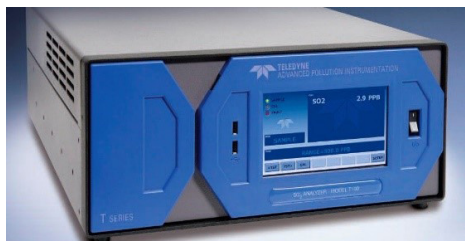
Figura 22. Analizador automático de Dióxido de Azufre
