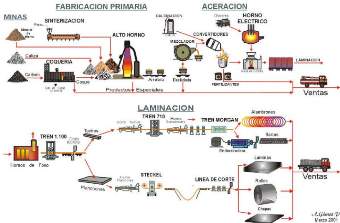
Figura 3-2. Diagrama de proceso APDR
