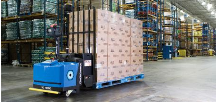
Figura 4.3 GP8 Pallet Truck de la empresa KMH en operación. *Imagen tomada de la página web de la empresa http://www.kmhsystems.com/
