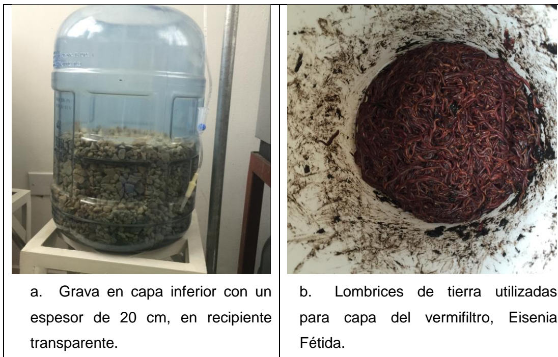
Figura 4-4. Registro fotográfico para el montaje del vermifiltro y filtro Control.
