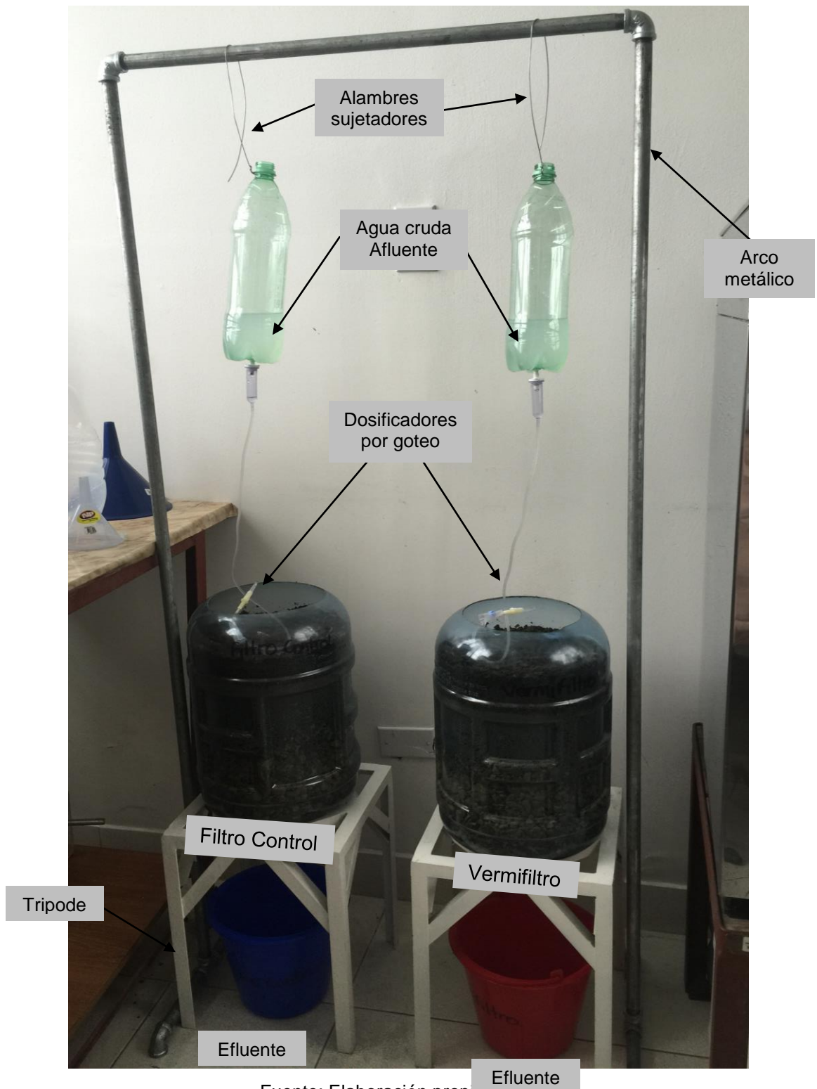
Figura 4-5. Montaje del vermifiltro y filtro control en el LIA
