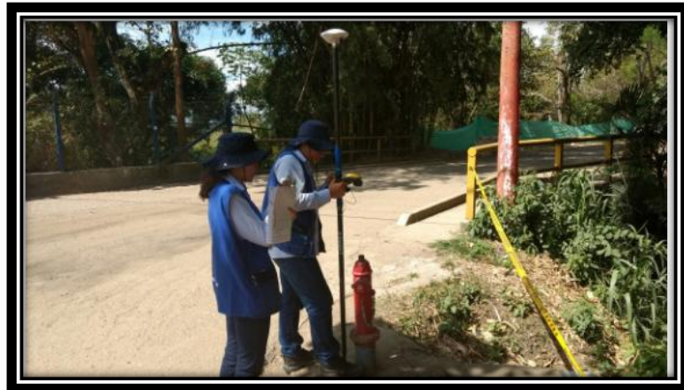
Imagen No 18 - Descripción de la imagen: Levantamiento de información de elementos de la red de acueducto - (Hidrantes - válvulas) FUENTE ALCALDIA DE IBAGUE. Empresa Ibaguerena de acueducto y alcantarillado, 2018
