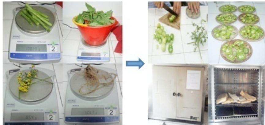
Figura 6. Secuencia para el secado de muestras
