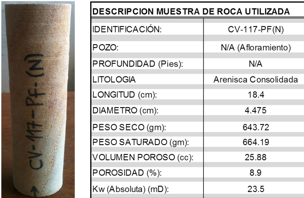
**Figura 4-10 Foto y propiedades muestra de roca usada en trabajo experimental.**
