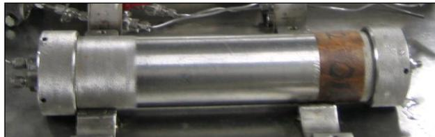
Figura 4-4 Cilindro de Desplazamiento de Líquidos.
