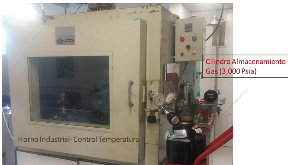
Figura 4-3 Horno Industrial y Cilindro de Acumulación de Gas.
