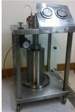
Figura 4-6 Subsistema de simulación de presión de poro
