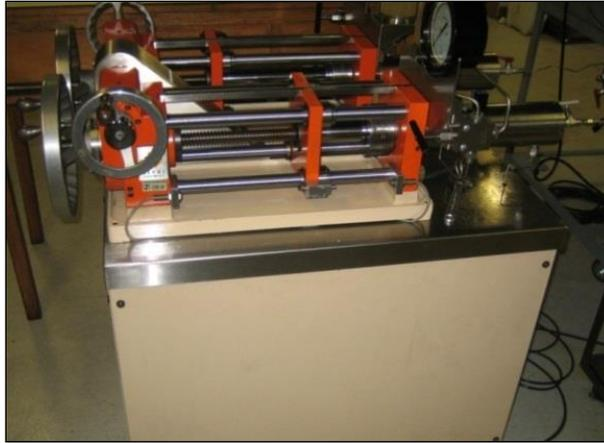
Figura 4-2 Bomba de desplazamiento Positivo.
