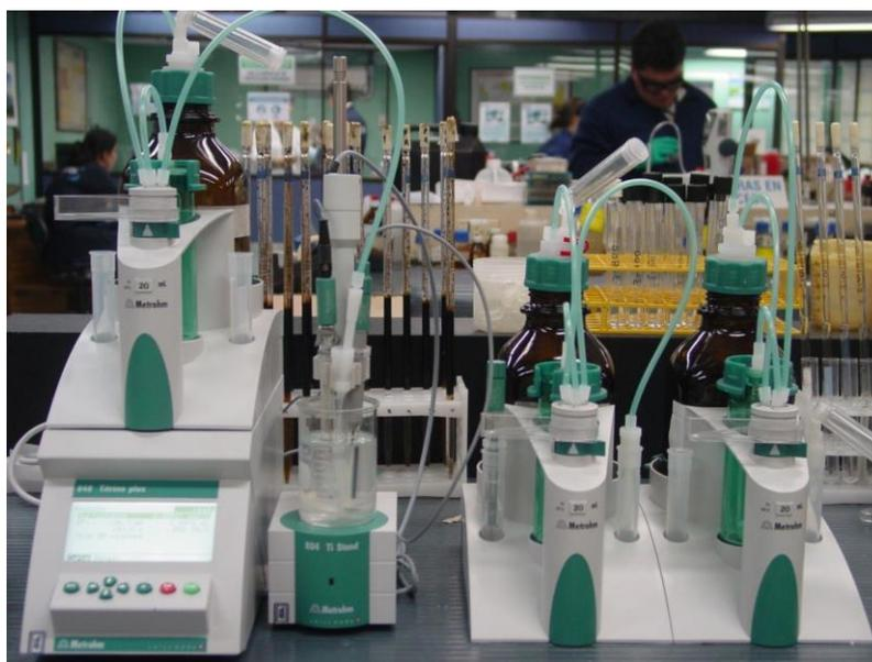
**Figura 4-9** Potenciómetro (Titrino Plus) para Medición de Concentración de Surfactantes.
