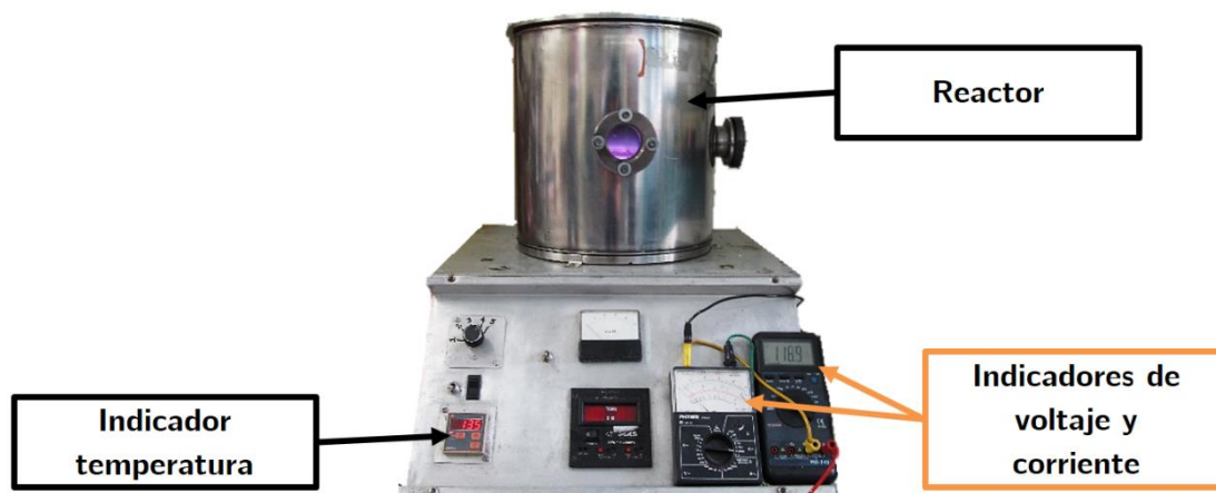
Figura 2-3: Reactor a plasma utilizado para tratamientos superficiales empleado en proceso de limpieza con plasma de los sustratos.
